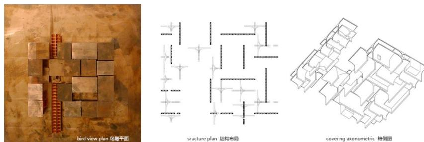
图 4-4 龙美术馆鸟瞰平面、结构布局、轴测图
