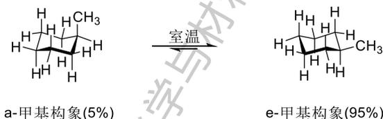
甲基在 a 键位置时, 与环同侧 C3 与 C5 上 a 键氢距离较近, 存在较大的空间排斥力; (图 2-13) 甲基在 e 键位置时, 与邻近的氢原子相距较远, 不存在上述空间排斥力。
