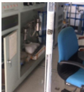
图 2-2 催化剂在反应管中的填装情况示意图
